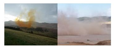
Figure 1 (L-R) Baseline blast fumes vs. TITAN  $\Delta E$  blast fumes
